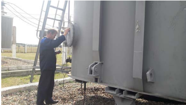
Рис. 1. Регистрация акустических сигналов подопытного трансформатора
